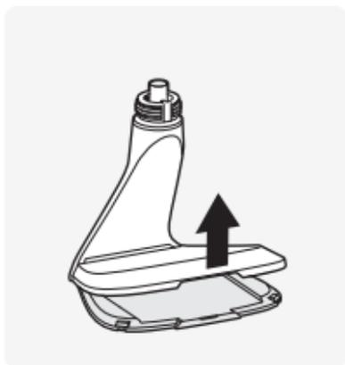
3. 使用2個螺絲固定底座。 4. 將外蓋安裝回去並轉回攝影機頭部。
